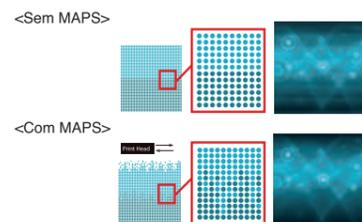
De acordo com as condições de impressão como mídia/tipo de tinta e resolução, um padrão de dispersão adequado é automaticamente selecionado e impresso.
