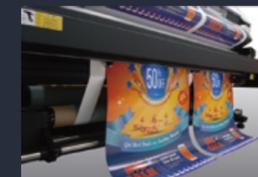
O corte em linha nas direções X e Y é possível. O sistema lê as marcas de registro dedicadas e corta automaticamente as folhas, reduzindo significativamente a mão de obra e otimizando todo o pós-processamento.
