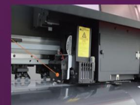
Equipado com sensor de atolamento de mídia, o risco de falha na cabeça de impressão é reduzido mesmo em situações em que ocorrem colisões com a mídia. Isso diminui significativamente o risco de danos causados por atolamentos em mídias com superfícies adesivas.
