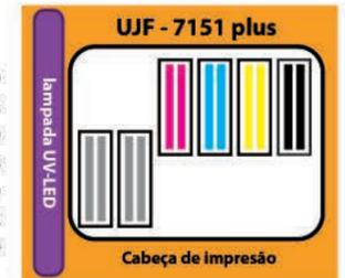
Com o novo sistema UV LED, a impressão e a cura do verniz são realizados simultaneamente. Esse novo método, reduz as bolhas na superfície de impressão, resultando em um acabamento uniforme.
