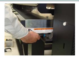
電源がオンになっている状態で、Y バーとテーブルの隙間に手を入れないでください。
