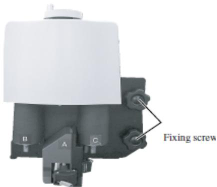
**Prenda ambos os parafusos de fixação na cabeça, alternadamente, começando pelo parafuso inferior.**
