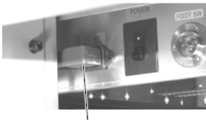
Insira o cabo de força para o ploter de entrada AC na caixa elétrica.
