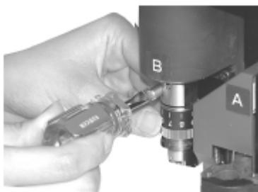
**Aperte o parafuso de trava com a parafusadeira fornecida com o dispositivo como acessório.**
