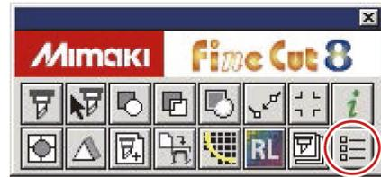
**3** Clique em [Output Condition Setup...] (Configuração das Condição de Saída...).
