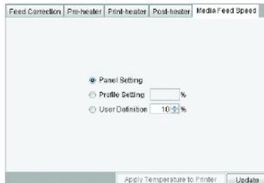
Se a Velocidade de Alimentação de Mídia padrão não alimentar corretamente, ajuste o valor da Velocidade de Alimentação de Mídia.
