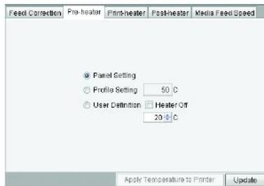
Ajusta a temperatura do pré-aquecedor.
