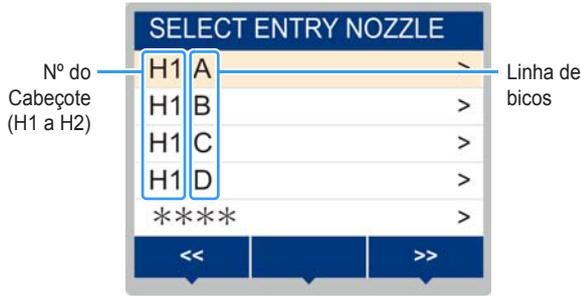
**8** Registre o número do bico que necessita ser recuperado e, em seguida, pressione a tecla **ENTER**.
