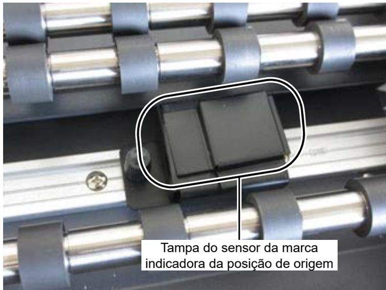
Tampa do sensor da marca indicadora da posição de origem
